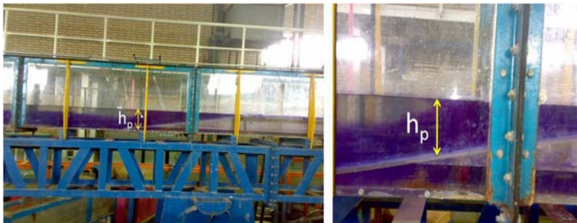
شکل ۳- تصویری از نقطه غوطه‌وری مشاهده شده در آزمایش‌ها
