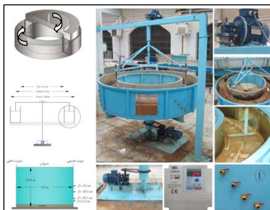
شکل ۲- نمایی از اجزای فلوم دایره‌ای مورد استفاده
