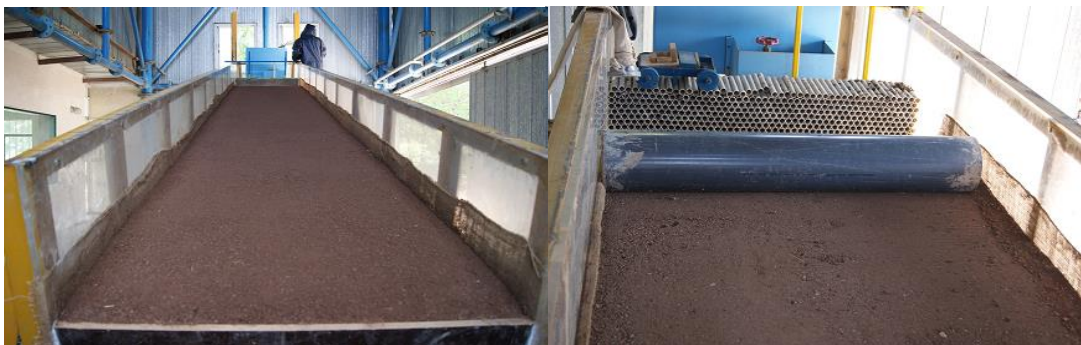
شکل ۲- دو نمای مختلف از فلوم شیبدار خاک غیر متحرک و حوضچه آرامش
