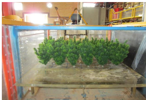
شکل ۳- نمایی از جنگل ساحلی و سیستم دریچه موج ساز در ابتدای فلوم
