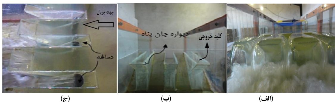
شکل ۲- نمایی از مدل سرریزهای مورد مطالعه، (الف) مدل ساده سرریز، (ب) سرریز با دیواره جان پناه، (ج) سرریز با دیواره جان پناه و دماغه
