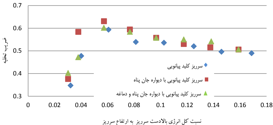
شکل ۹- نمودار ضریب تخلیه در برابر نسبت کل انرژي بالادست سرریز به ارتفاع سرریز
