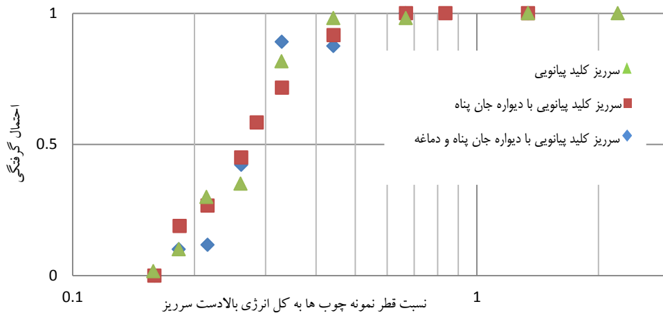
شکل ۲- احتمال گرفتگی نمونه های شاخه دار در برابر نسبت قطر نمونه چوبها به کل انرژی بالادست سرریز
