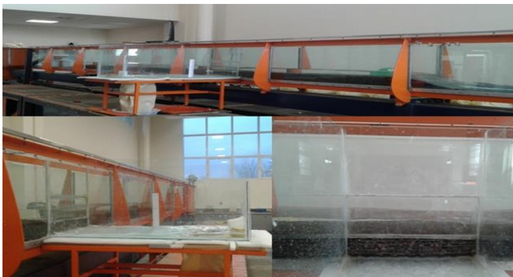
شکل ۲- کانال آزمایشگاهی، کانال انحراف و آبگیر کفی محیط متخلخل
