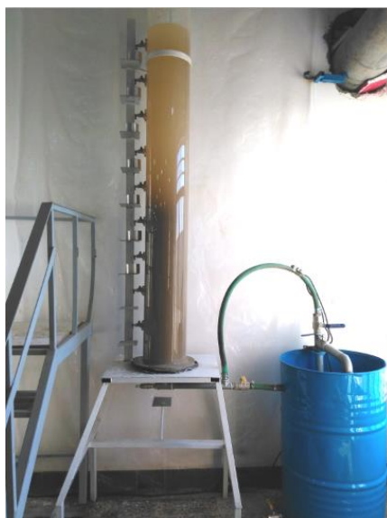
شکل ۴- نمایی از مدل فیزیکی استوانه ته نشینی
