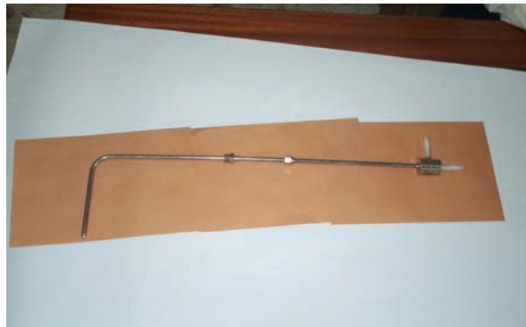
شکل ۵- لوله پیتو جهت اندازه گیری سرعت جریان
