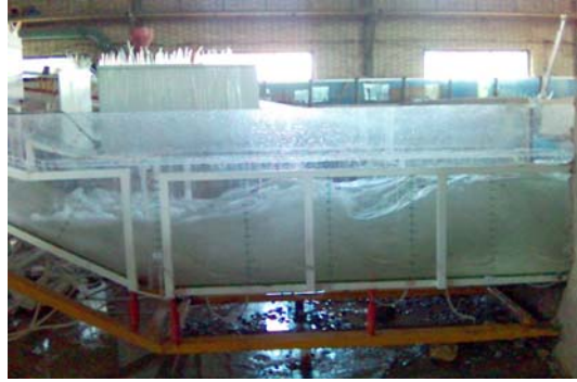
شکل ۴- حالت سوم تشکیل پرش هیدرولیکی، پرش مستغرق
