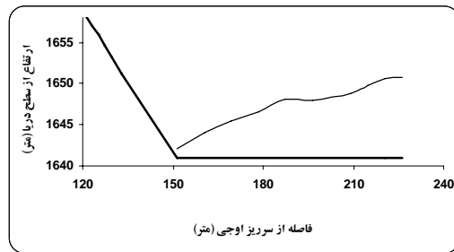
شکل ۸- پروفیل سطح آب در دبی ۳۵۵/۸ متر مکعب بر ثانیه
