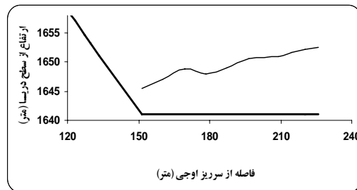
شکل ۹- پروفیل سطح آب در دبی ۴۵۰ متر مکعب بر ثانیه
