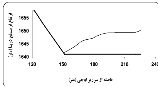
شکل ۷- پروفیل سطح آب در دبی ۲۲۱/۷ متر مکعب بر ثانیه
