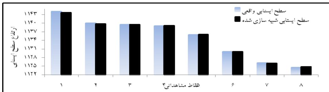
شکل ۳- تراز سطح ایستابی اندازه‌گیری شده و واسنجی شده در حالت پایدار در نقاط مشاهداتی
