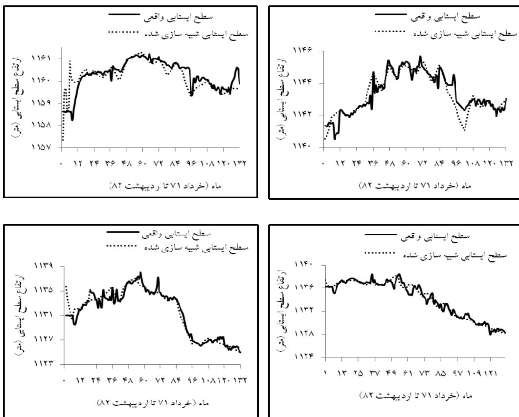
شکل ۴- توازن سطح ایستایی واقعی و واسنجی شده در حالت ناپایدار برای چهار پیزومتر
