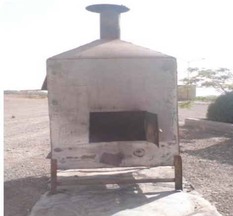
شکل ۱- کوره مورد استفاده برای سوزاندن بقایای گیاهی
