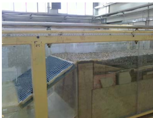
شکل ۴- نمای جانبی رسوبات بالادست کف مشبک
