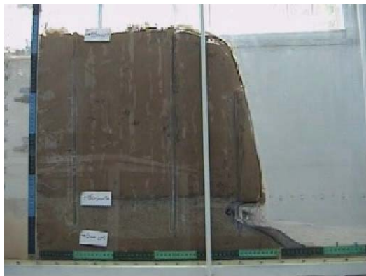
شکل ۵- پسروری مربوط به دانه‌بندی ۰/۴-۰/۸ میلی‌متر
