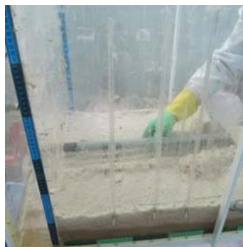
شکل ۴- قرار دادن لوله در لایه‌ی ماسه‌ای
