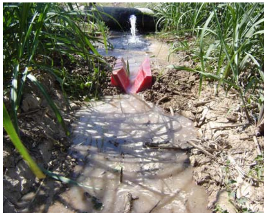
شکل ۳ - فلوم WSC و پیشروی آب در جویچه
