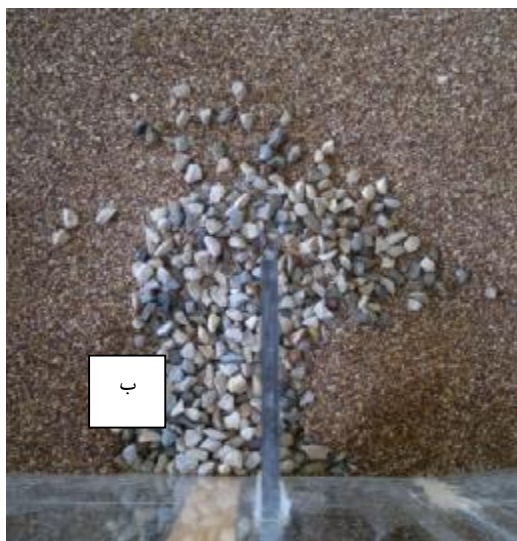
شکل 4- نحوه چیدمان ریپ ریپ در اطراف آبشکن‌ها: الف) قبل از شکست و ب) بعد از شکست
