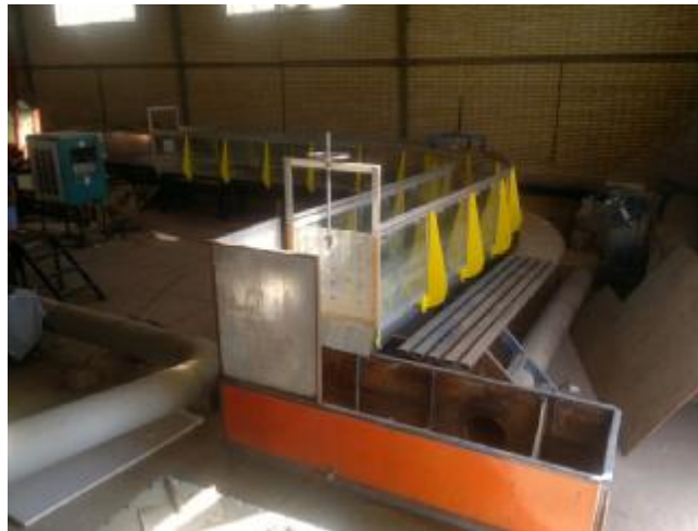
شکل 1- نمایی از فلوم قوسی مورد استفاده در این تحقیق
