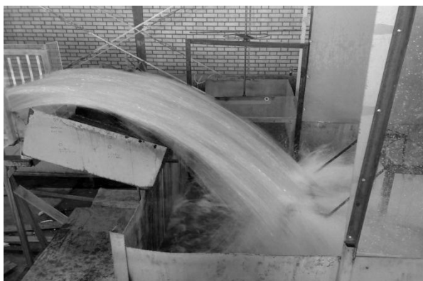
شکل ۴- برخورد جت آب به صفحه اندازه‌گیری فشار
