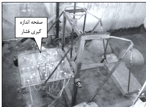
شکل ۳- وسیله ایجاد زاویه و صفحه اندازه‌گیری فشار
