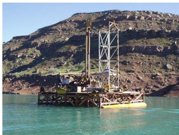
شکل ۲- شناور حفاری مورد استفاده جهت نمونه‌بردای از رسوبات مخزن سد دز
