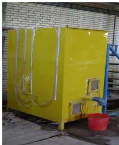
شکل ۴- نمای خارجی مخزن خاک و شن
