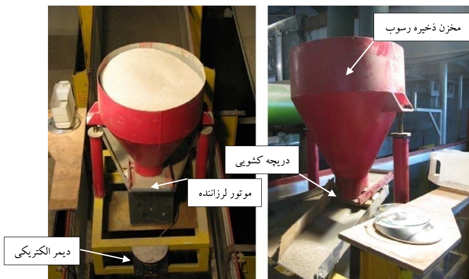
شکل ۳- نمایی از دستگاه تزریق رسوب و اجزای تشکیل دهنده آن
