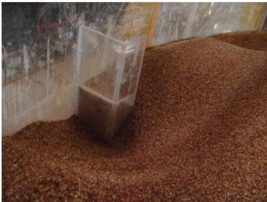
شکل ۱۶- نمونه‌ای از آزمایش انجام شده ( آبشکن L با اندازه بال ۱۰/۵ سانتی‌متر، Q=25.4 لیتر بر ثانیه و \phi=90^\circ ) بستر قبل و بعد از آبشستگی
