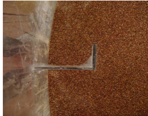
شکل ۱۶- نمونه‌ای از آزمایش انجام شده ( آبشکن L با اندازه بال ۱۰/۵ سانتی‌متر، Q=25.4 لیتر بر ثانیه و \phi=90^\circ ) بستر قبل و بعد از آبشستگی
