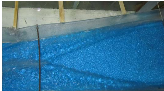
شکل ۴- تشکیل امواج ضربه‌ای در تبدیل مدل یک به ازای Fr_1=7
