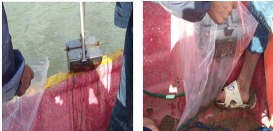
شکل ۳ - نحوه نمونه گیری از رسوب بستر مخزن سد سفید رود
