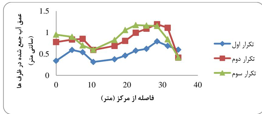
شکل ۷- نیم‌رخ عمق پاشش آبپاش سیستم آبیاری ارابه‌ای در حالت ثابت
