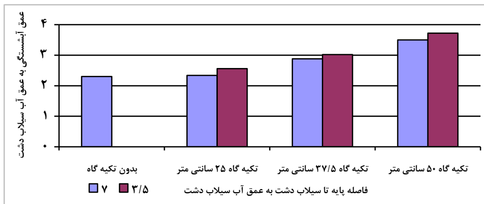
شکل ۱۳- تأثیر فاصله پایه از سیلاب دشت در حضور تکیه گاه بر روی آبستگي پایه نوک تیز
