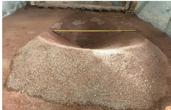
شکل ۴- الگوی آبشستگی ناشی از جت دایره‌ای
