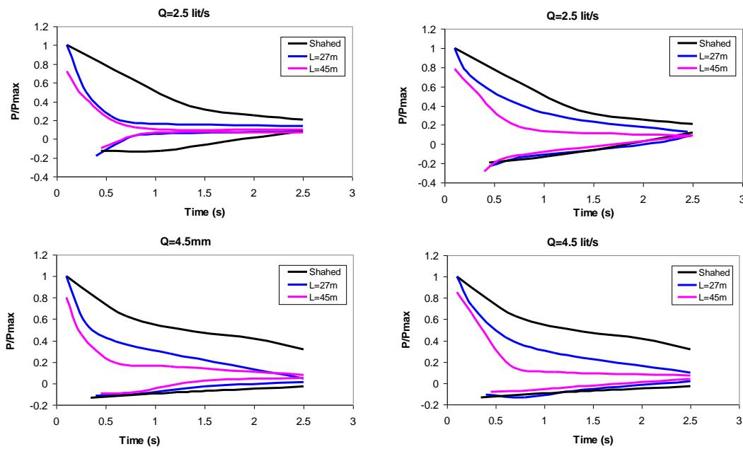
شکل ۹- اثر تغییر مکان نشت بر استهلاک موج فشاری در بستن آنی شیر ( $T_c \approx 0.1$  ثانیه)
