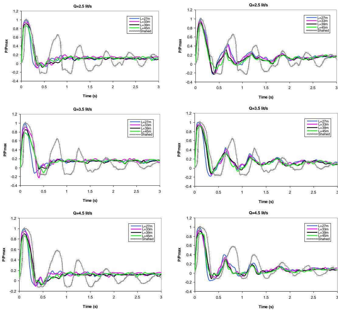
شکل ۷-۱۰ تغییر مکان نشت بر امواج فشاری جریان غیرماندگار برای بستن کند شیر ( $T_c = 0.6$  ثانیه) با قطر نشت معادل ۱۰ میلی‌متر
