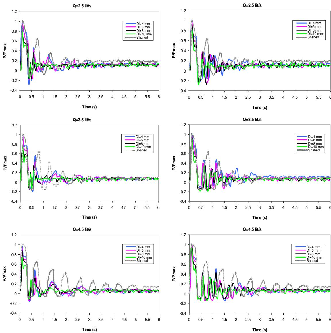
شکل ۴- اثر تغییر قطر نشت بر امواج فشاری جریان غیرماندگار برای بستن آنی شیر (ثانیه ۰/۱  $\equiv T_c$ )
