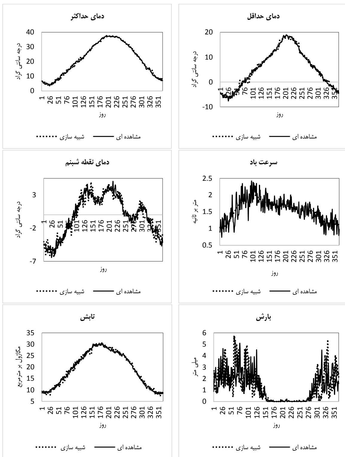
شکل ۳- مقایسه مقادیر شبیه سازی شده با مقادیر اندازه گیری شده در ایستگاه سنتدج
