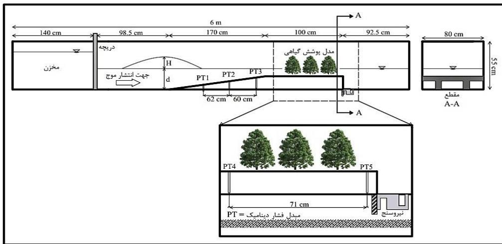
شکل ۴- سیستم و مدل‌های مورد نیاز برای انجام آزمایش‌ها در فلوم
