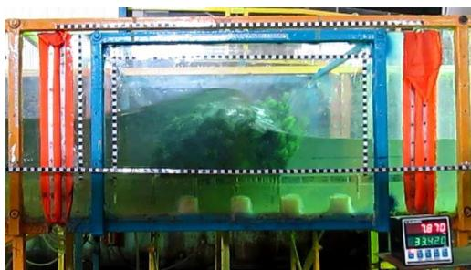
شکل ۵- نمایی از پروفیل عرضی موج شکنا در حالت با پوشش و بدون پوشش
