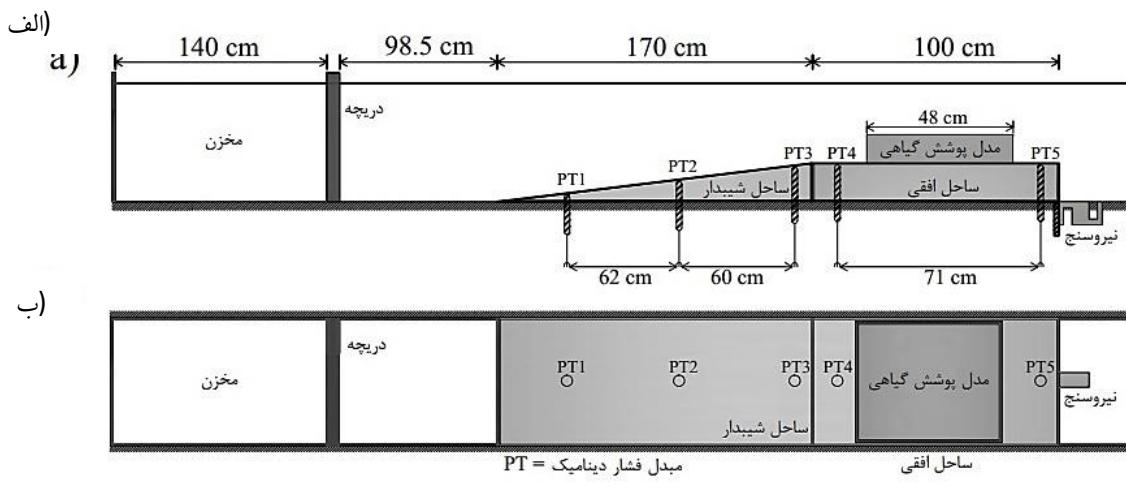
شکل ۲- به ترتیب (الف) نمایی از مقطع فلوم مستطیل شکل، و (ب) نمایی از پلان فلوم مستطیل شکل
