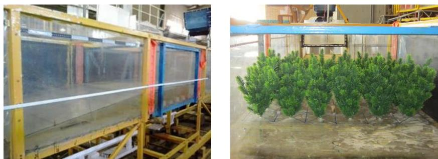
شکل ۳- نمایی از مدل تاج‌پوشش کمربند سبز ساحلی و مدل شب ساحل
