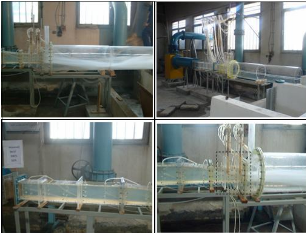
شکل ۱- تصاویری از بخش‌های مختلف مجرا، دریچه‌ها پیزومترها و تونل خروجی در مدل فیزیکی ساخته شده
