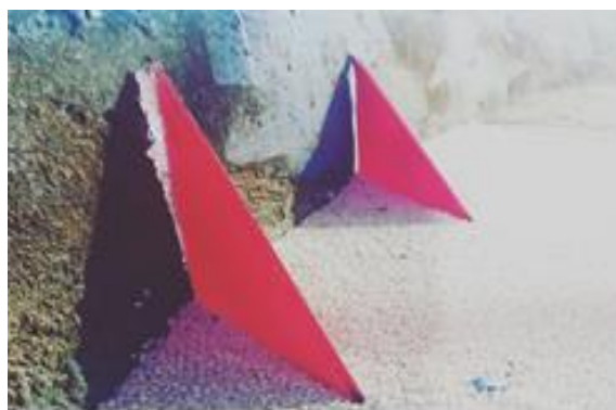
شکل ۵- نحوه قرارگیری صفحات متصل به ساحل در مجرا
