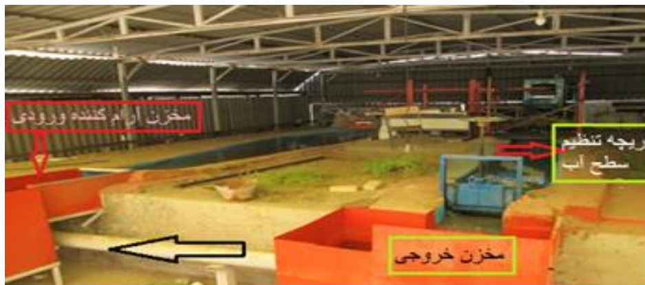
شکل ۴- مشخصات مدل فیزیکی قوس جنگیه و متعلقات آن
