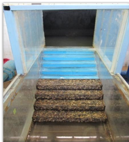
شکل ۱- مقطع فلوم آزمایشگاهی مورد استفاده در این مطالعه (عرض فلوم ۵۶ سانتی متر)
