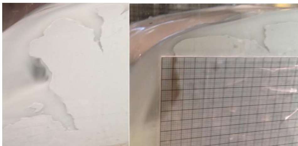
Fig. 5- Cracks formed in Test 5 شکل ۵- ترک‌های ایجاد شده در آزمایش ۵
