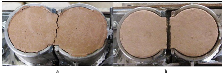
Fig. 5- Breakage of some samples; (a) sample made from soil with 20% humidity and \gamma_d = 1.62 \frac{gr}{cm^3} , (b) 7-day sample stabilized with 2% lime and 3% cement شکل ۵- گسیختگی برخی نمونه‌ها؛ (a) نمونه ساخته شده از خاک با رطوبت ۲۰ درصد و \gamma_d = 1.62 \frac{gr}{cm^3} ، (b) نمونه هفت روزه تثبیت شده با دو درصد آهک و سه درصد سیمان
