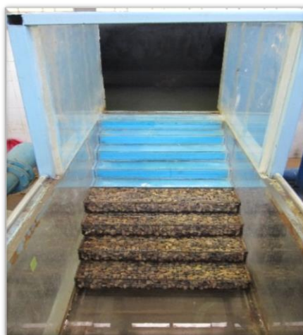
Fig. 2- The placement method of gabion baskets on the stepped spillway شکل ۲- نحوه قرارگیری سبدهای گابیون بر سرریز پلکانی
